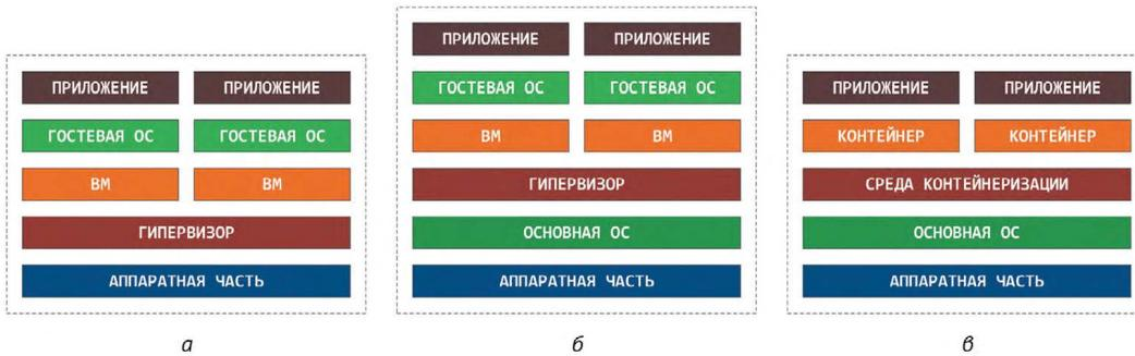
Рис.2. Структура основных типов виртуализации
